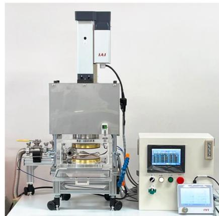
市場には存在しないため、プラスチック製マイクロ流体デバイス接合に特化した新型拡散接合装置を開発した。接合精度向上と自動化、タッチパネル化、より高精度な接合を実現した。これまでの研究で得られた接合条件をレシピとして入力することで、未熟練者でも熟練者と同様の接合が可能である。
